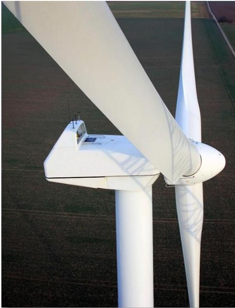
Con rotore tripala, questa pala eolica ha regolazione del passo controvento e imbardata attiva. Il rotore, funziona a velocità variabile, ottimizzando l'efficienza aerodinamica. Il passo è variabile e gli angoli delle pale sono costantemente regolati nella posizione ottimale del vento, ottimizzando così la produzione di energia e i livelli di rumorosità.
